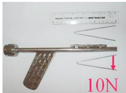
Рис. 2. Устройство для введения пучка спиц. V-образные спицы. Напряжение между концами спиц – 10 N
